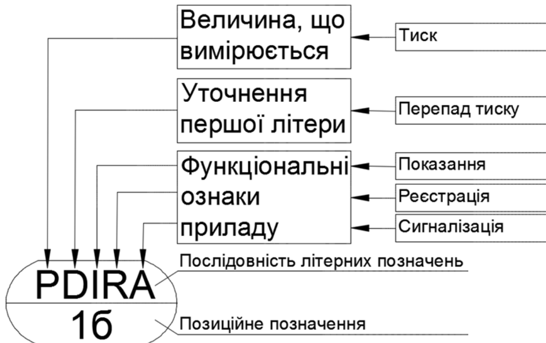
Рисунок 1.6. Умовне позначення засобів автоматизації
