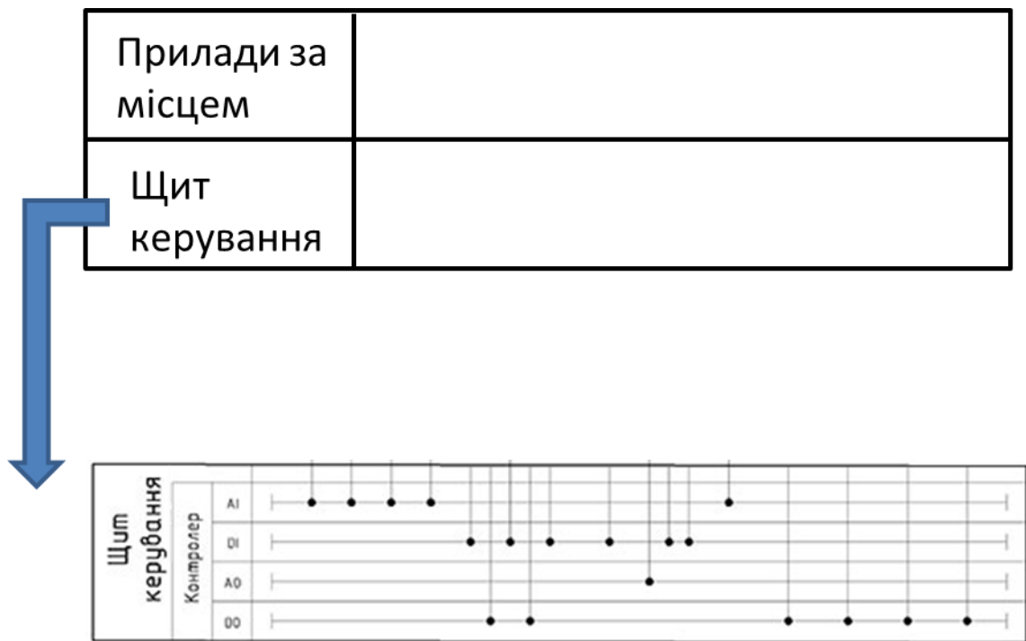
Рисунок 1.9. Умовне зображення щита та місцевих приладів на ФСА
