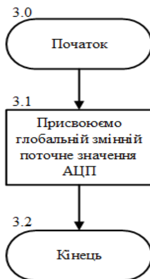
Рисунок 4.42 – Схема алгоритму обробки переривання завершення перетворення АЦП
