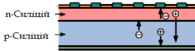
Рис. 3.17. Міграція електронів і дірок під дією світла
