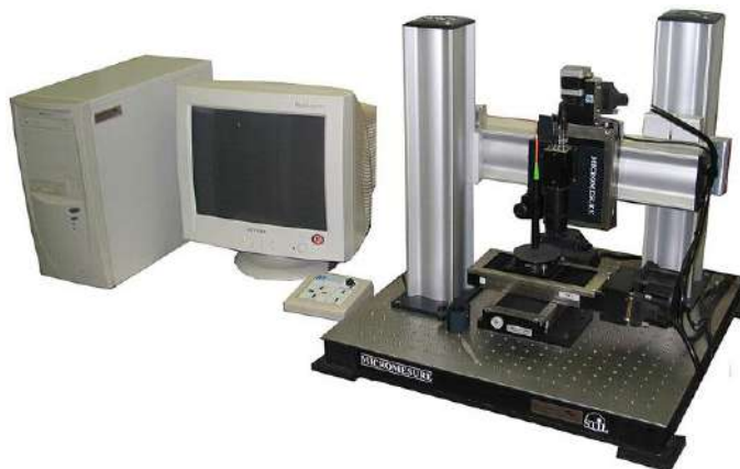
Рис. 2.6. Стационарный оптический профілометр MICROMESURE SURF
