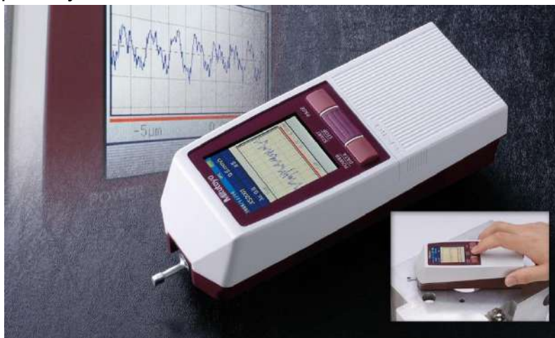
Рис. 2.1. Контактний профілометр Mitutoyo JIS2001 (Японія)
