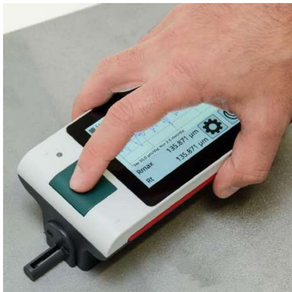
Рис. 2.2. Контактні профілометри: а) профілометр дисплейний; б) профілометр моделі-296
