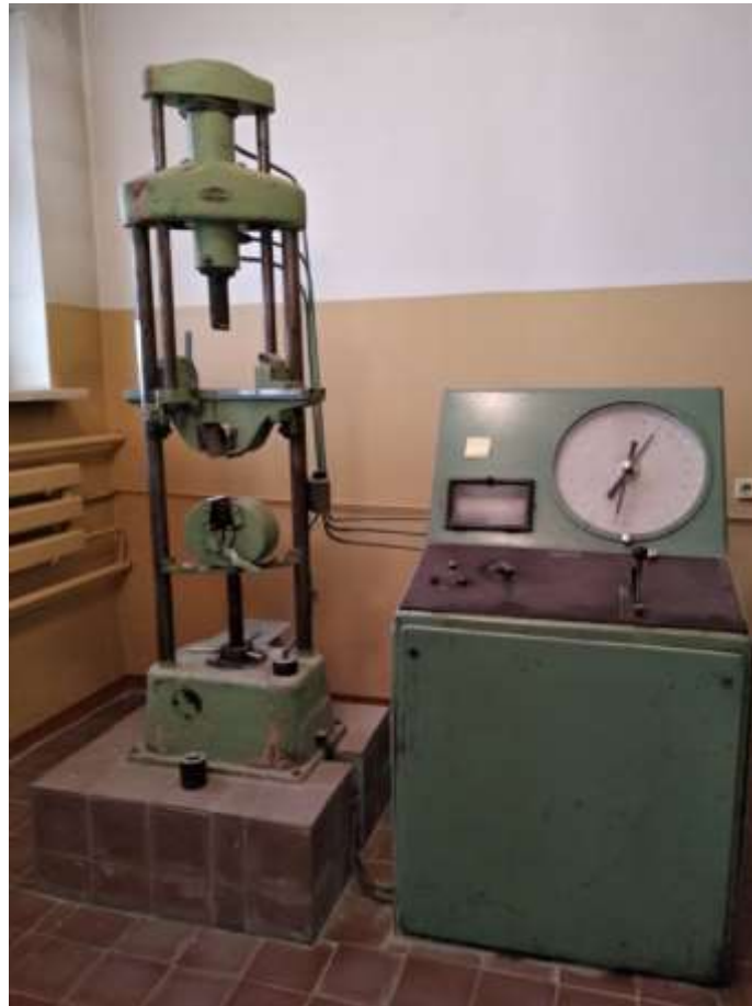
Рисунок 2.26 – Розривна машина типу УММ-5 (фото взято з відкритих джерел)
