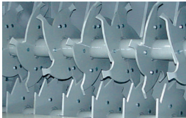
Рисунок 2.2 – Елементи ножів дробарки EKZ
