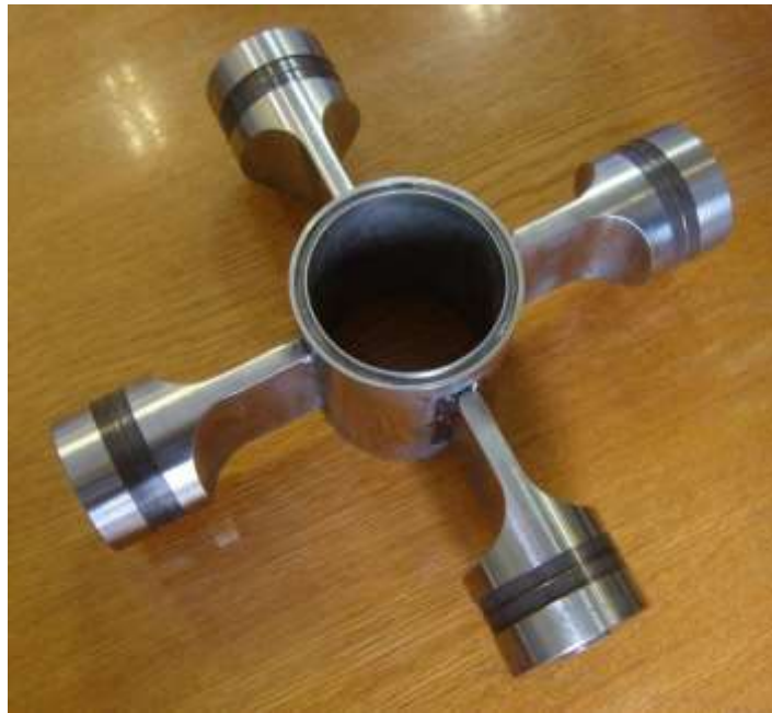
Рис. 2.39 – Модульна ультразвукова кавітаційна секція з трубчастим вібратором
