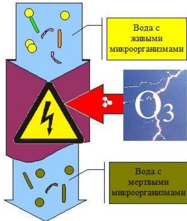
Рис. 1.2 – Схема знезараження рідкого середовища на основі озону
