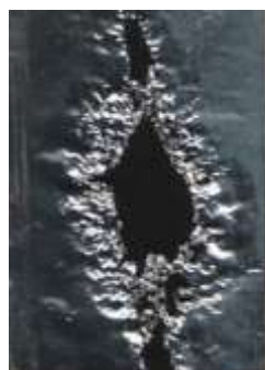
Рис. 2.52 – Зміна площі кавітаційного руйнування тестової фольги при різних рівнях надлишкового тиску
