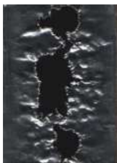
Рис. 2.52 – Зміна площі кавітаційного руйнування тестової фольги при різних рівнях надлишкового тиску
