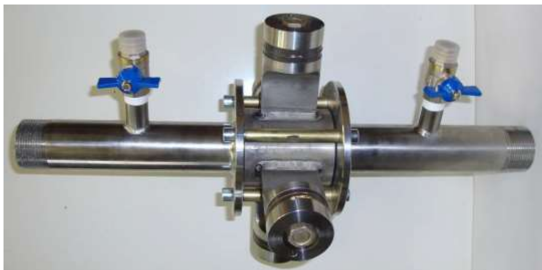
Рис. 1.48 – Приклад виготовлення проточного ультразвукового трубчастого вібратора підвищеної інтенсивності
