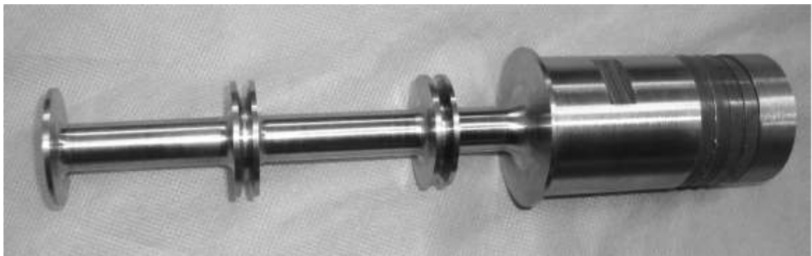
Рис.2.14 – Високоамплітудний ультразвуковий випромінювач з розвиненою багатодисковою поверхнею випромінювання
