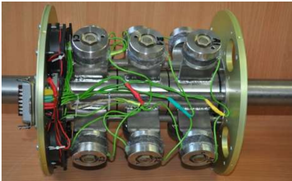
Рис. 1.49 – Пристрій для ультразвукової кавітаційної обробки рідини в потоці
