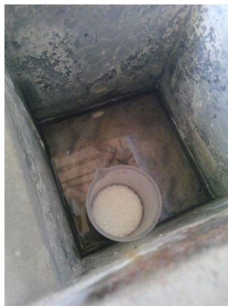
Рис. 4.14. Розміщена проба АС/ДП на діафрагмі з заповненою водою
