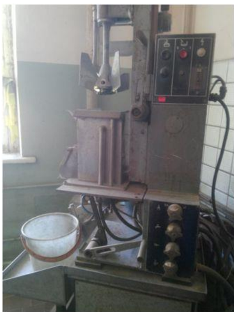
Рис. 4.14. Розміщена проба АС/ДП на діафрагмі з заповненою водою
