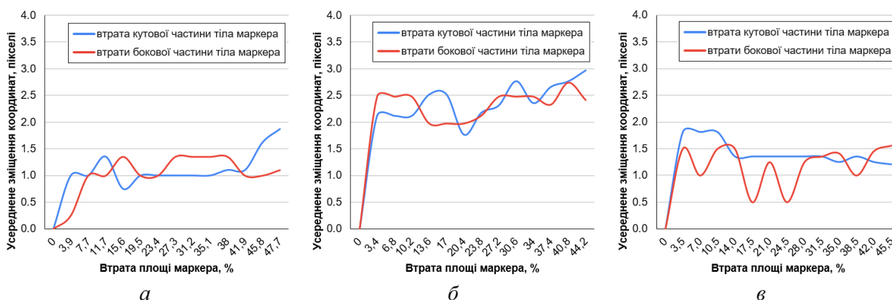
Рис. 3. Усереднене зміщення координат добудованого маркера по відношенню до оригінального: a – для маркерів DICT_4X4 із розміром 3x3 см; б – для маркерів DICT_4X4 із розміром 5x5 см; в – для маркерів DICT_7X7 із розміром 5x5 см.
