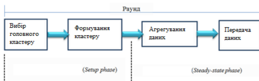
Рис. 1.10 Блок-схема протоколів маршрутизації на основі кластеризації (процес кластеризації)
