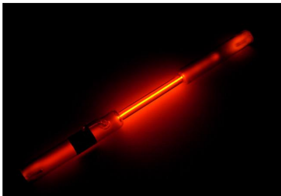
Рисунок 1.3 — Неонова лампа, в основі функціонування якої лежить тліючий розряд
