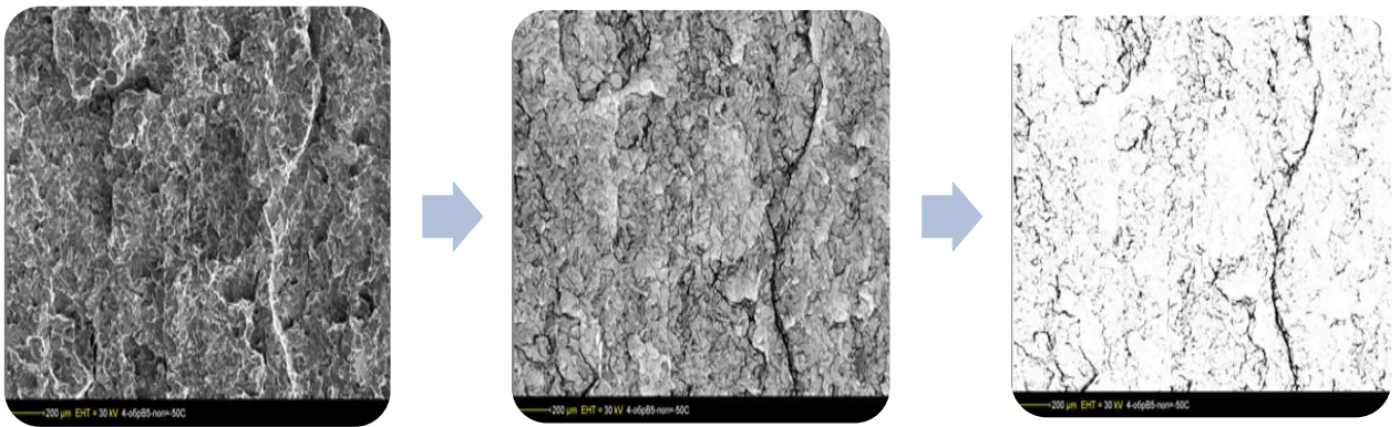
Рисунок 2.2 - Етапи обробки зображення, для роботи із структурною характеристикою – границя зерна
