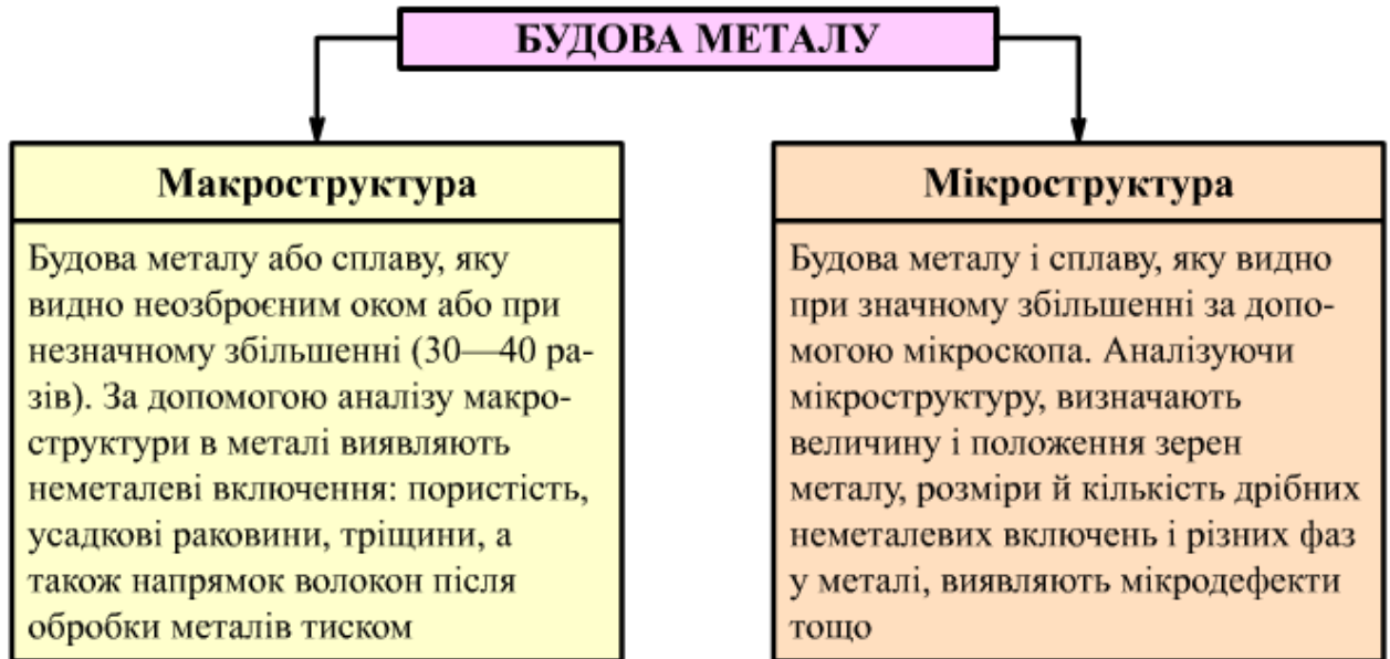
Рисунок 2.1 - Методи дослідження будови (структури) металу
