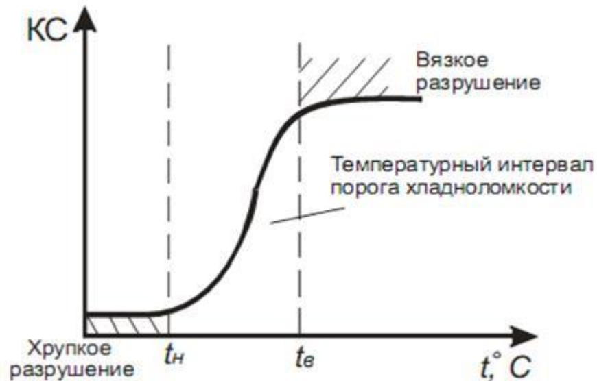
Рисунок 3.3 -Залежність ударної в'язкості від температури сталі
