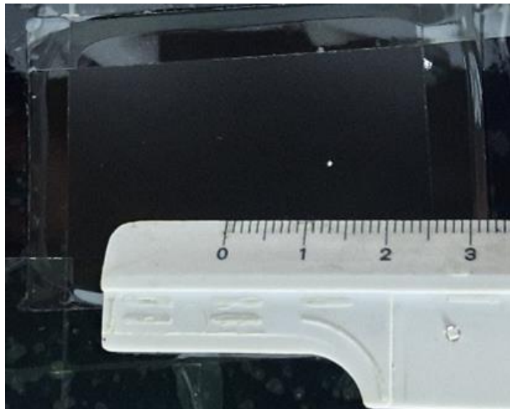
Рис.76. Зображення на екрані фокусної плями лінзи з напиленням шару ПТФЕ товщиною 53,606 нм
