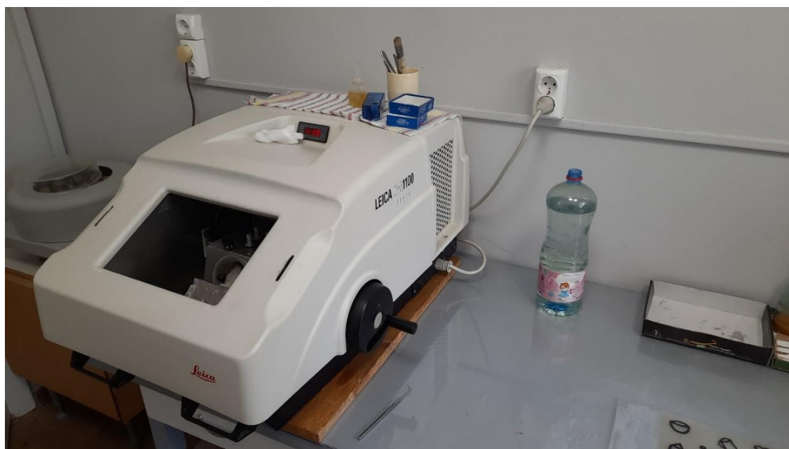
Рис.69 Механічний мікротом Leica CM 1100
