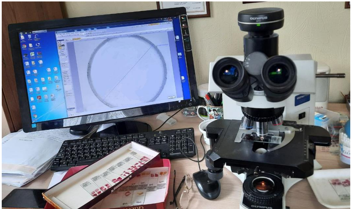
Рис. 67. Спостереження поверхні ІОЛ на мікроскопі BX41 Olympus
