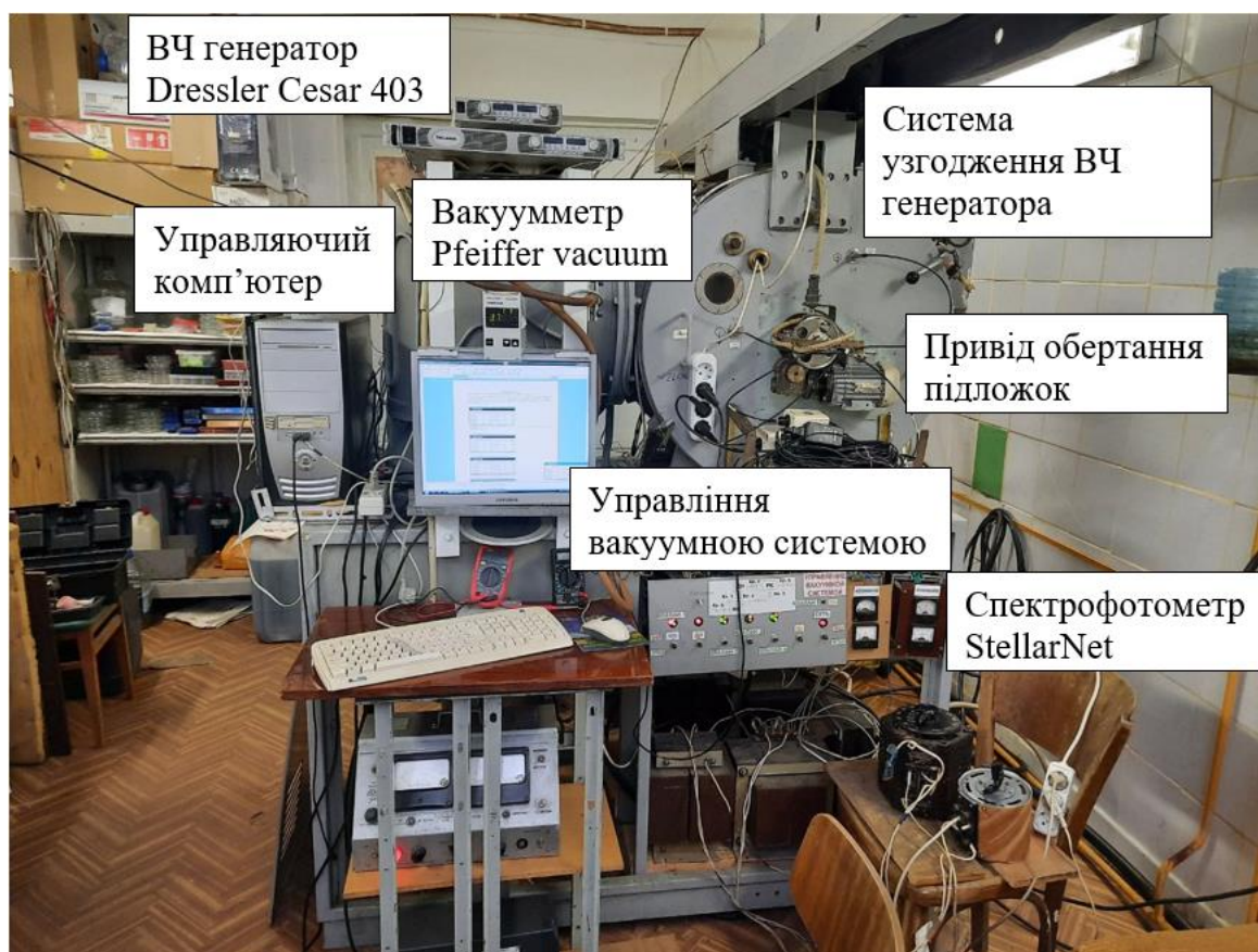
Рис.52 Установка вакуумного напилення УВН-74
