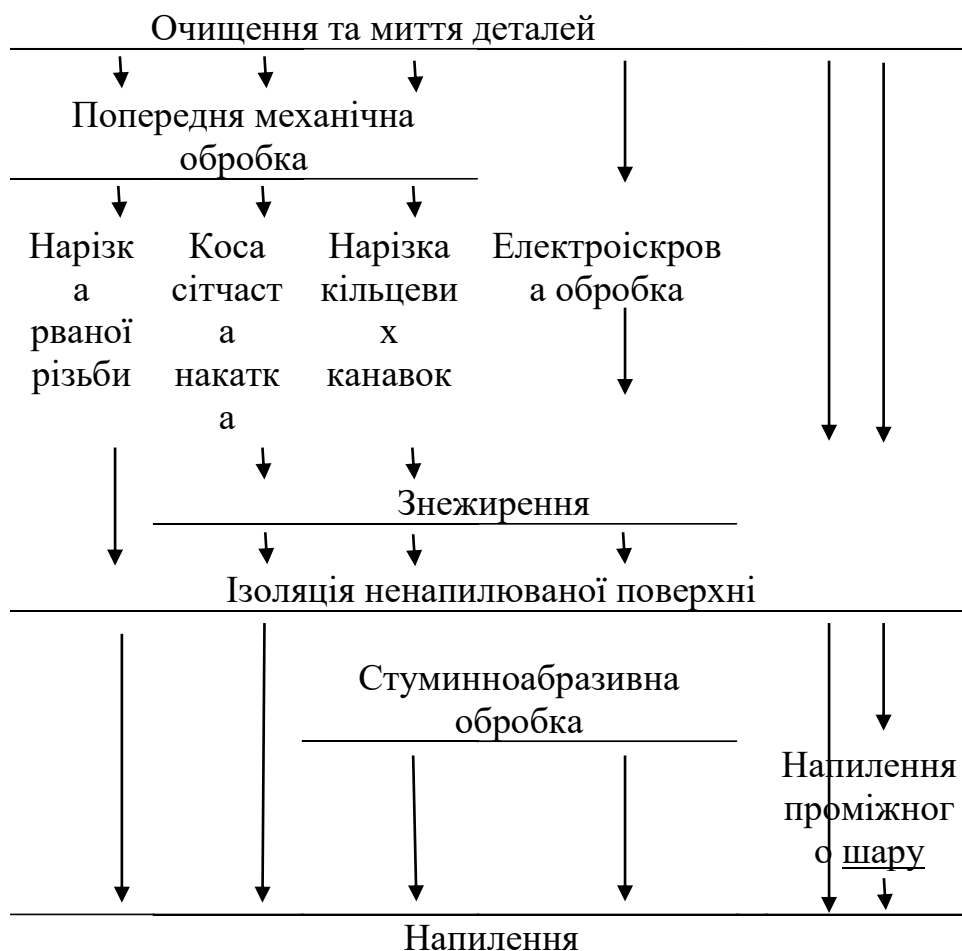
Рисунок 4.7 – Взаємозв’язок операцій підготовки поверхні за газотермічного напилювання
