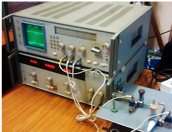
Рисунок 2.3 — Зовнішній вигляд панорамного аналізатора Р2-69
