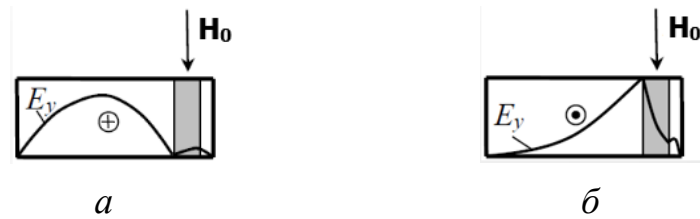
Рисунок 3.6 — Поле падаючої (а) та відбитої (б) хвилі типу H_{10} в прямокутному хвилеводі з підмагніченою феритовою пластину
