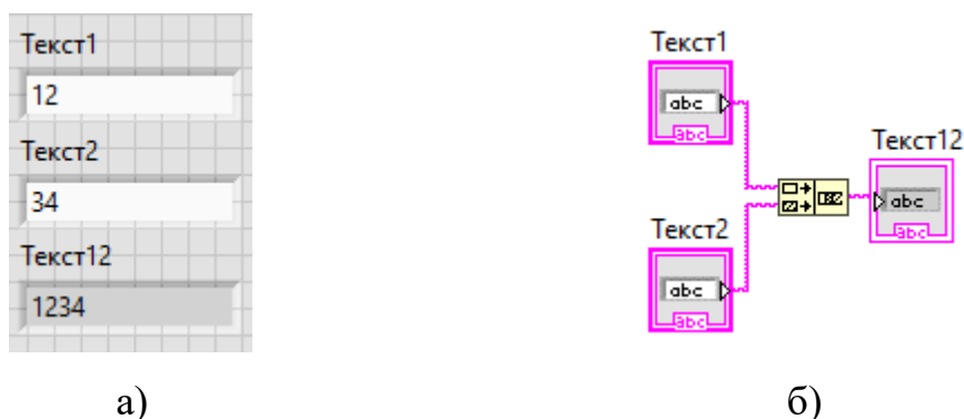
Рисунок 6.8 — ВП до прикладу 6.3: а) передня панель; б) блок-діаграма
