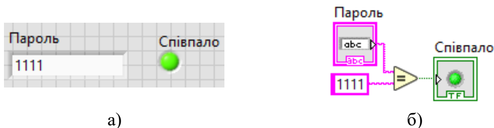
Рисунок 6.9 — ВП до прикладу 6.4: а) передня панель; б) блок-діаграма
