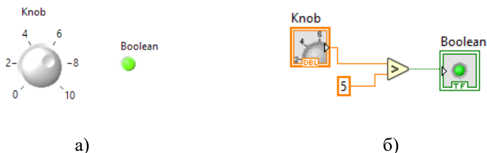
Рисунок 1.7 — Приклад віртуального приладу: а) передня панель; б) блок-діаграма
