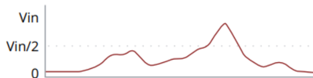
Рисунок 3.7 — Приклад сигналу виведеного з електроміографічного датчика [7]
