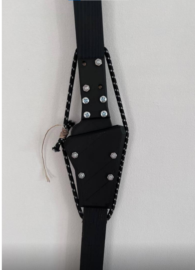
Рисунок 4.1. Рухоме з'єднання екзоскелета в зборі.
