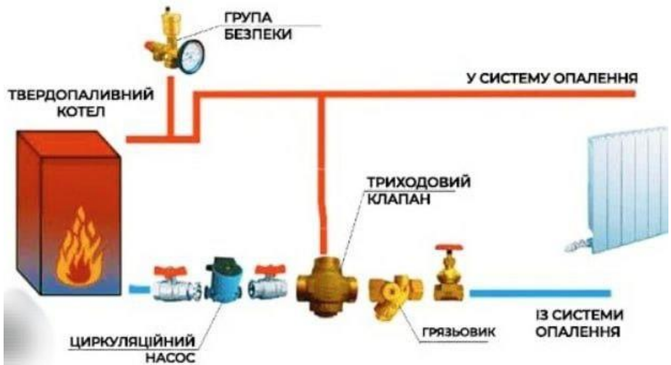
Рисунок 2.22 – Схема роботи обігріву за допомогою твердопаливного котла
