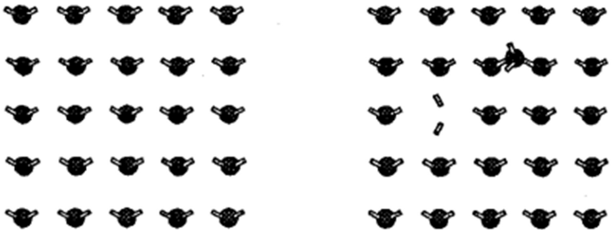
Рисунок 1.3 – Створення пари порожнини та надповерхневого атома для поверхні типу (001)
