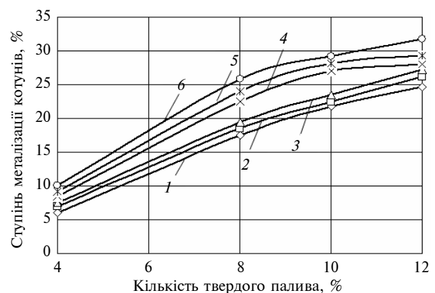
Рис. 3. Зміна ступеня металізації котунів різної основності за температур спікання 1553 і 1593 К залежно від вмісту в них твердого палива: 1 – неофлюсовані котуни, випалені за температури 1553 К; 2 – котуни основністю 1,4, випалені за температури 1553 К; 3 – котуни основністю 1,9, випалені за температури 1553 К; 4 – неофлюсовані котуни, випалені за температури 1593 К; 5 – котуни основністю 1,4, випалені за температури 1593 К; 6 – котуни основністю 1,9, випалені за температури 1593 К
