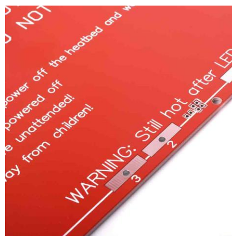
Рисунок 3.39 - Контакти живлення нагрівального столу МК2В
