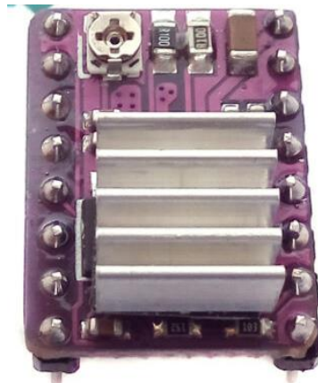
Рисунок 3.17 - Система охолодження DRV8825
