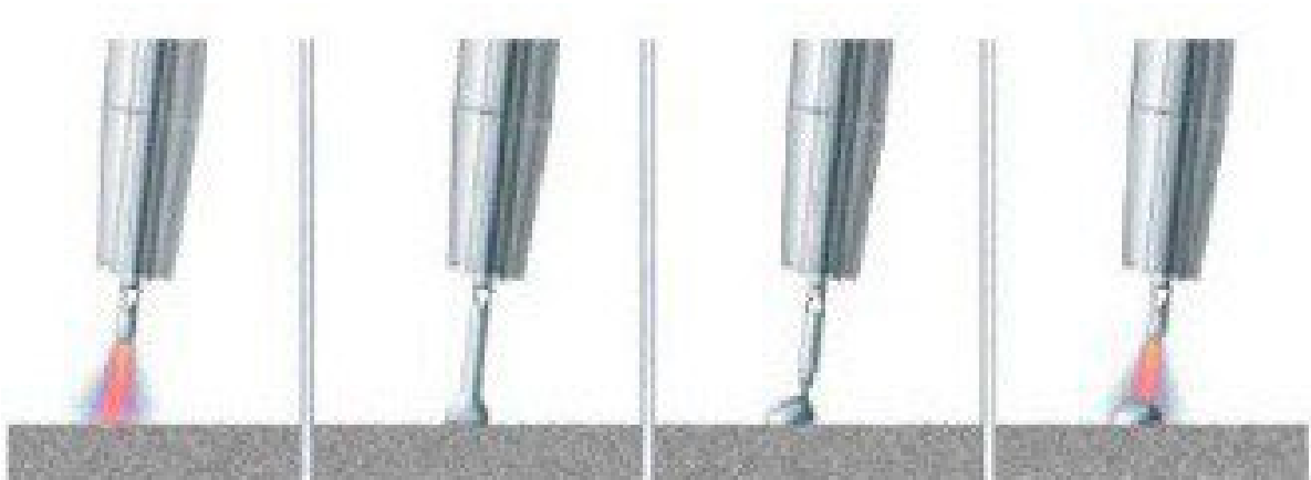
Рисунок 1.16 - Стадії перенесення металу в процесі CMT [6]
