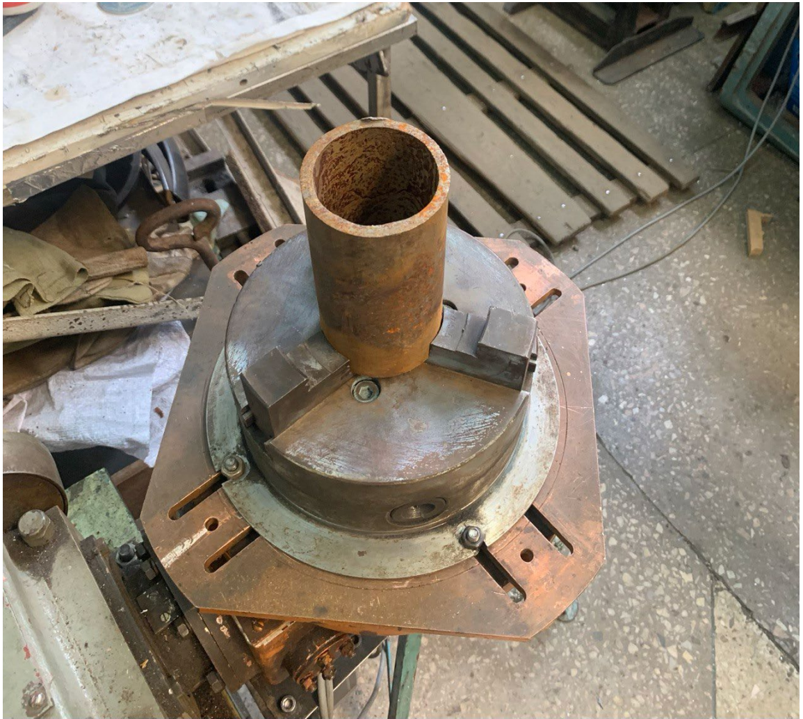
Рисунок 4.1 – Фіксація труби перед наплавленням
