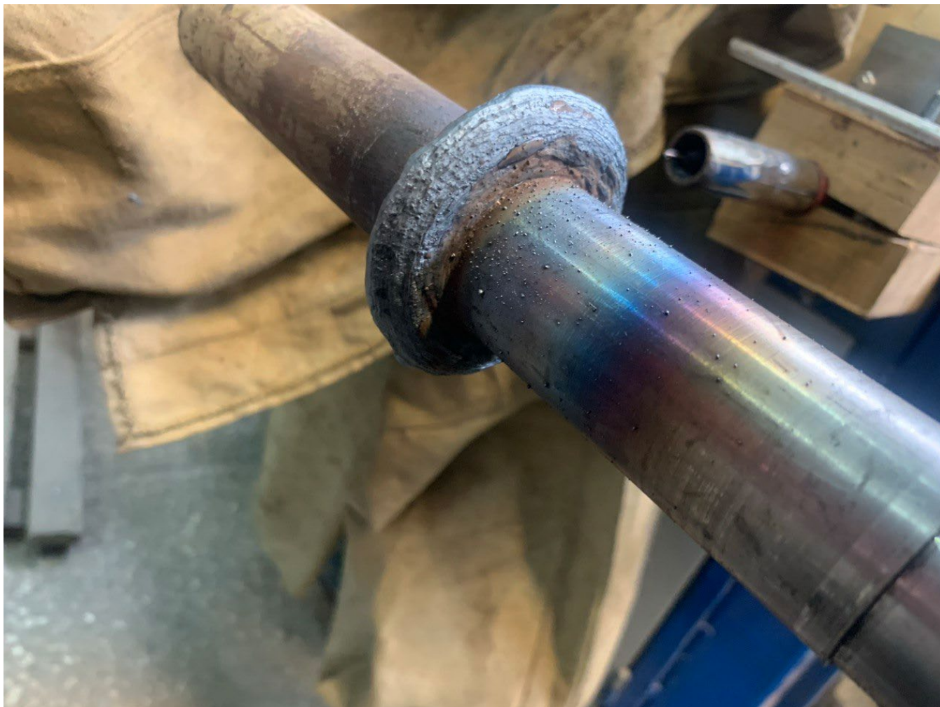
Рисунок 4.5 – Наплавлення на валу
