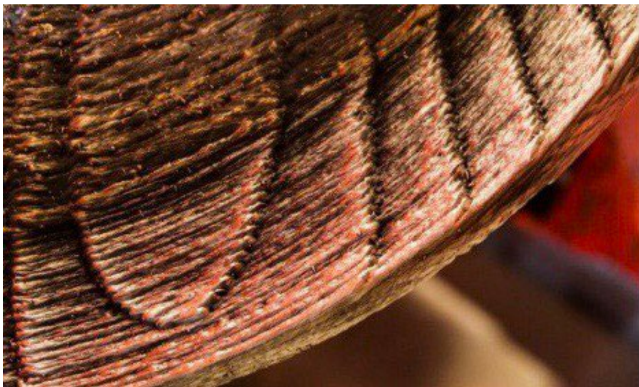
Рисунок 1.15 - Надрукований на 3D-принтері гребний гвинт [5]
