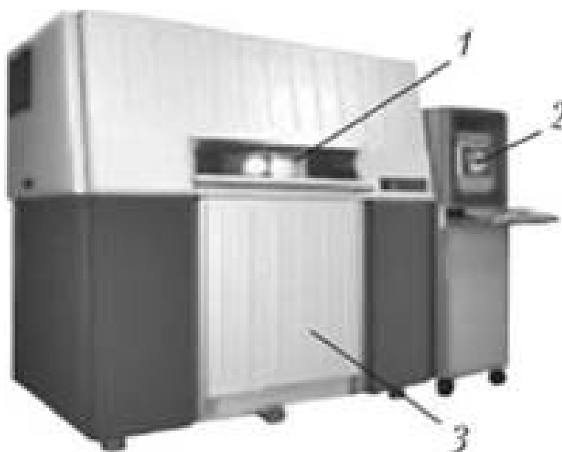
Рисунок 1.5. Установа виборчого лазерного спікання:
