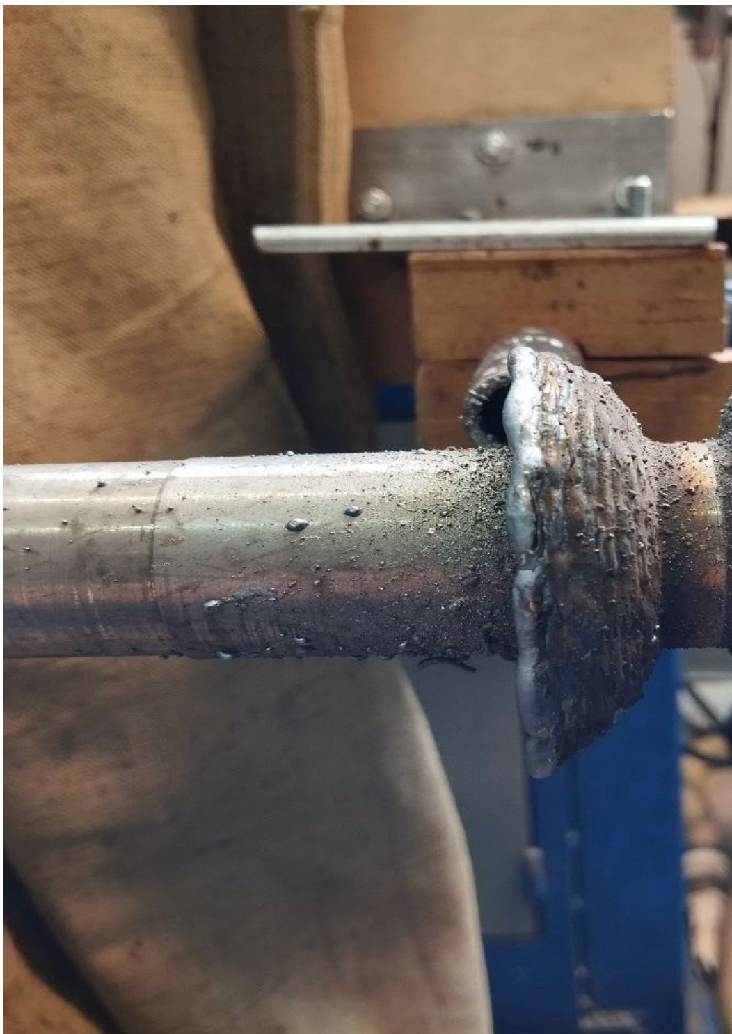
Рисунок 4.6 – Наплавлення на валу
