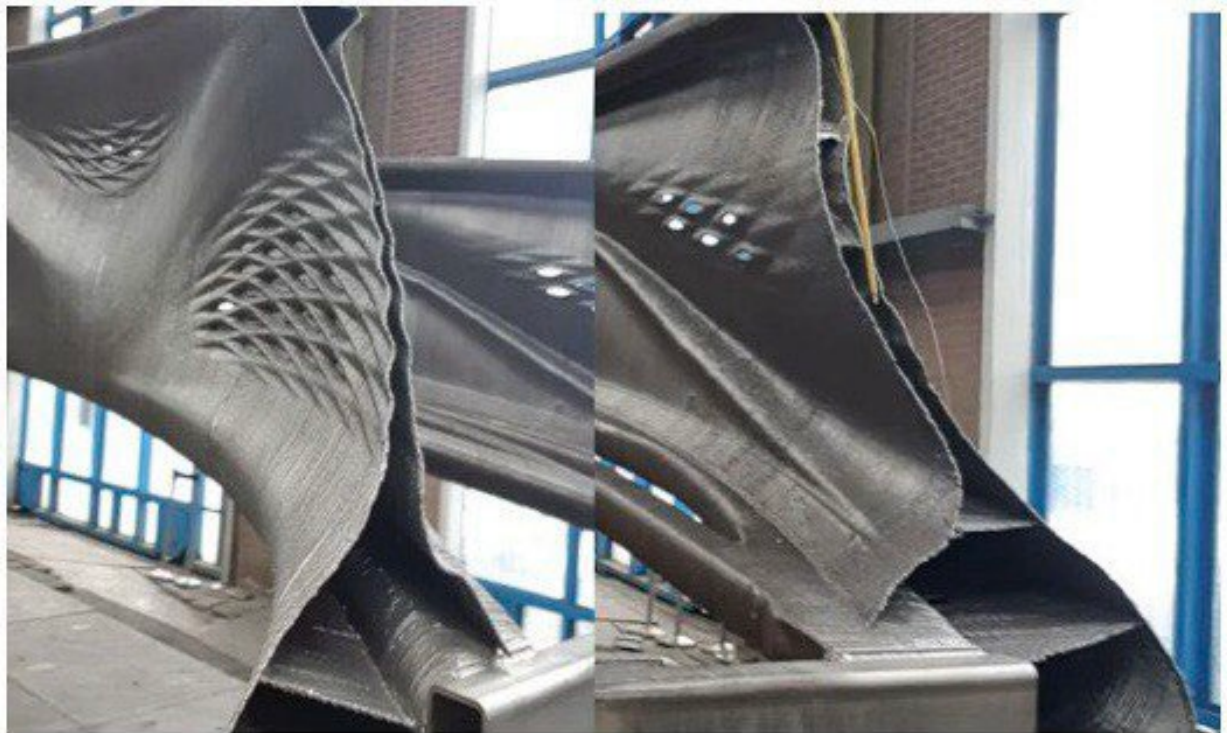
Рисунок 1.19 – Виготовлення пішохідного мосту методом Wire-Arc Additive Manufacturing [7]
