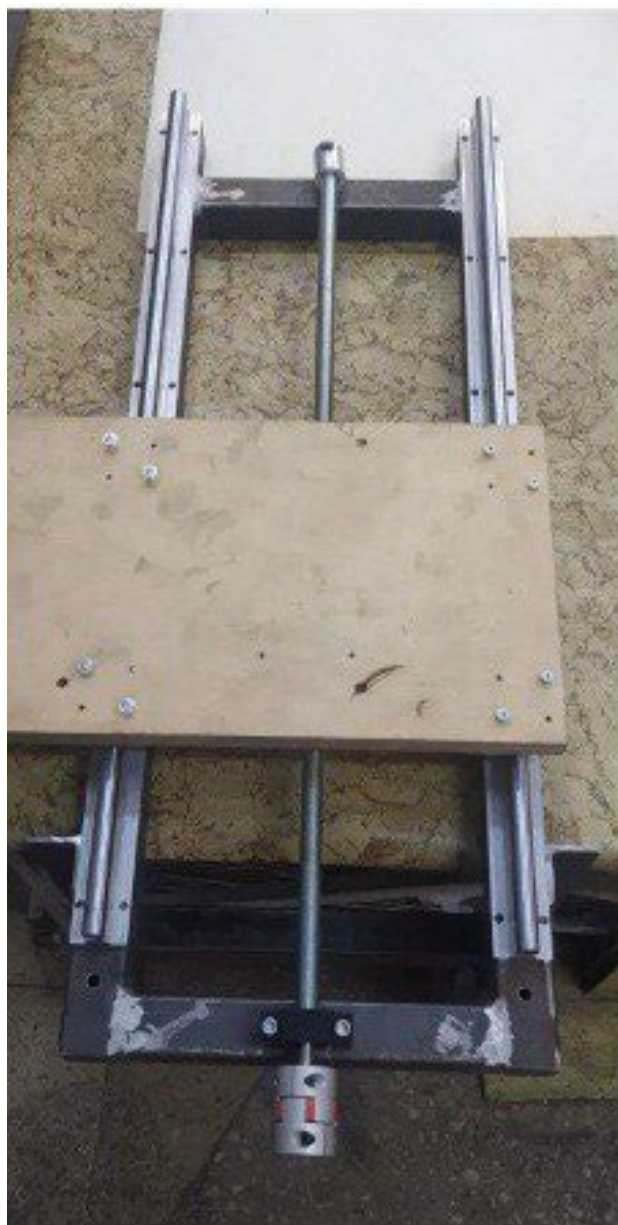
Рисунок 3.4 – Кронштейн з закріпленою різьбовою шпилькою M16
