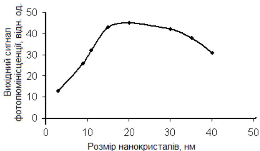
Рис. 7.20. Залежність інтенсивності фотолюмінесценції плівок нанопористого кремнію на довжині хвилі 650 нм від розмірів нанокристалів
