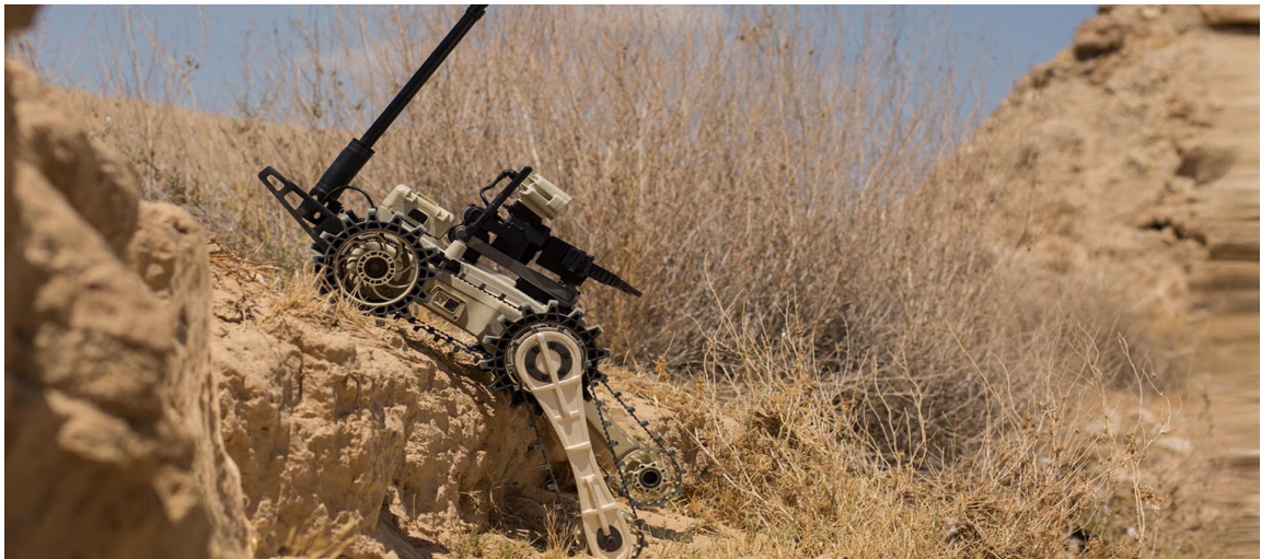
Рис.1.22. Робот долає перешкоди за допомогою фліперів
