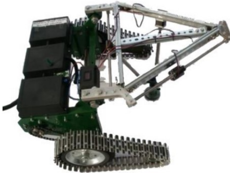
Рис.3.8. Зібраний мобільний робот для маніпулювання небезпечними об'єктами
