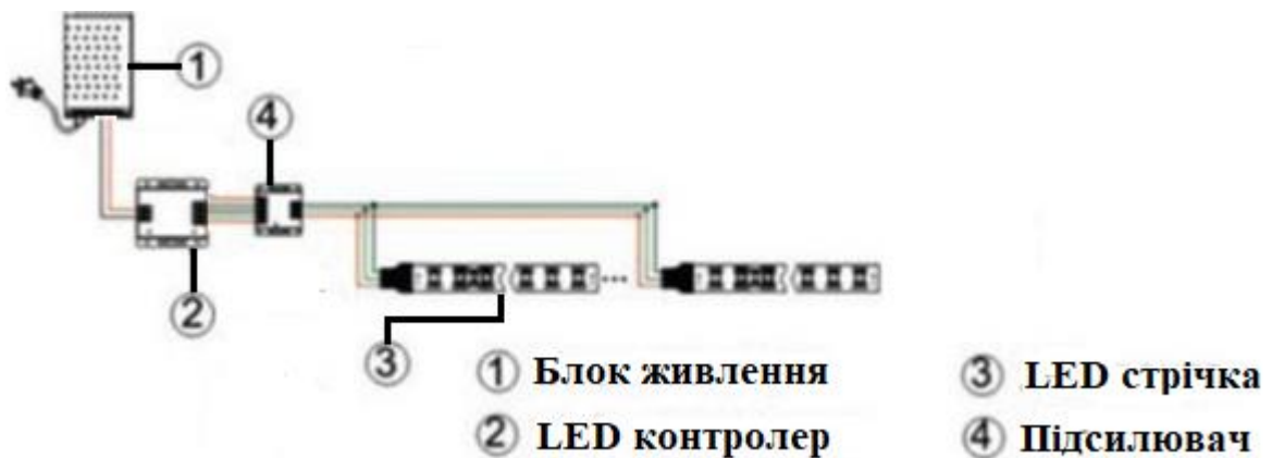
Рис. 2.9 Схема підключення підсилювача RGB
