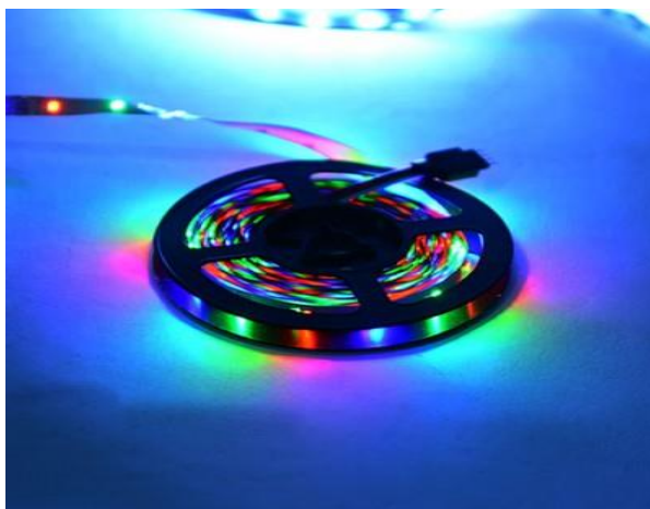
Рис. 2.12 Зовнішній вигляд світлодіодної стрічки REN/RGB 12V DC IP65
