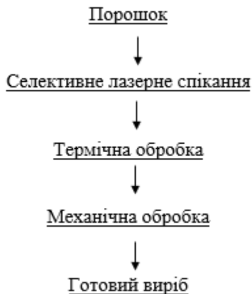
Рисунок 1.4 – Схема технологічного процесу отримання виробів методом селективного лазерного спікання
