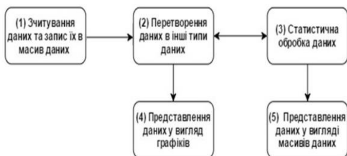
Рисунок 1.11 – Алгоритм роботи комп'ютерної моделі для обробки спекл-інтерферограм у дослідженні [16]
