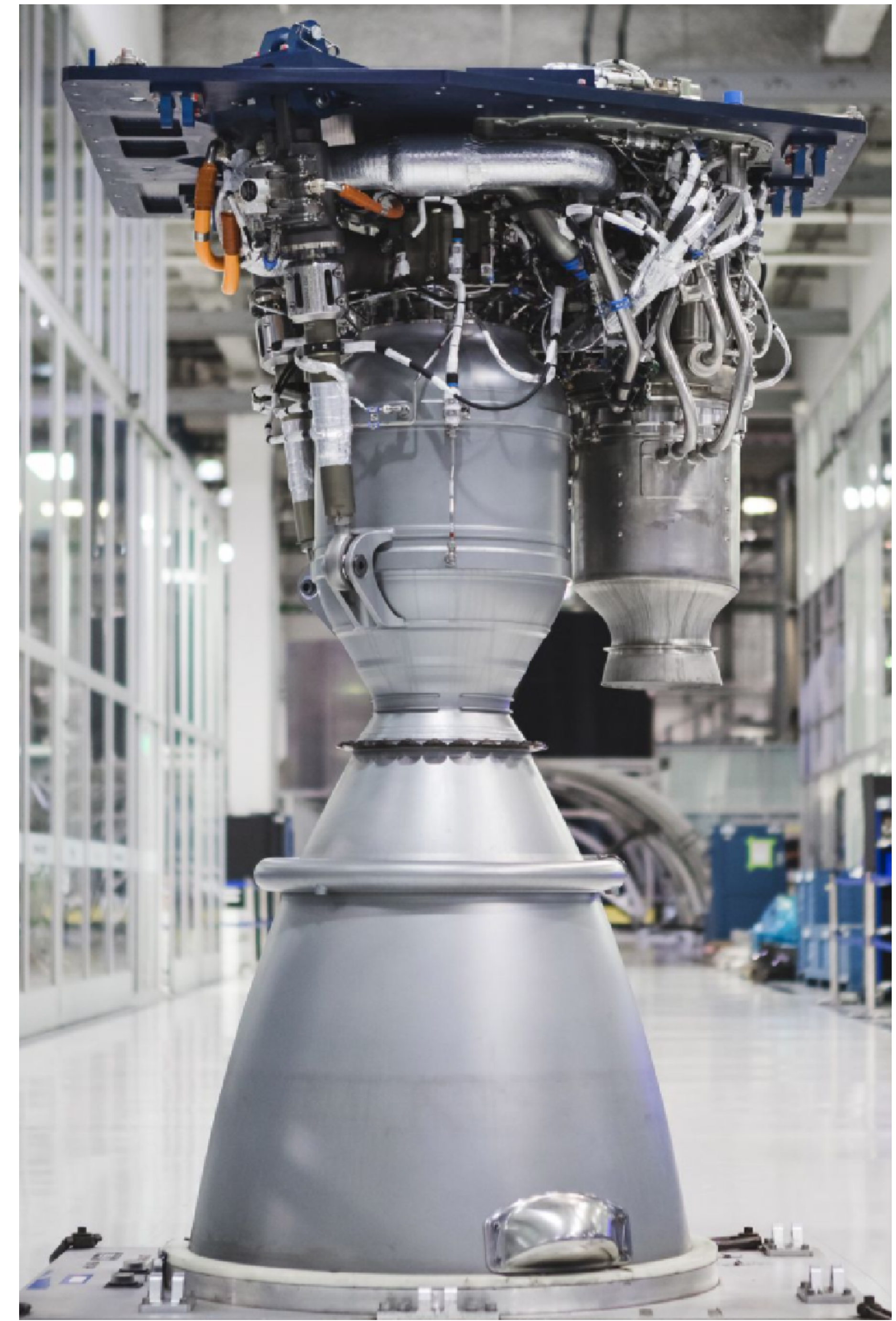
РРД "Merlin" SpaceX - неземкнута схема -привід ТНА від турбіни - питомий імпульс 275с
