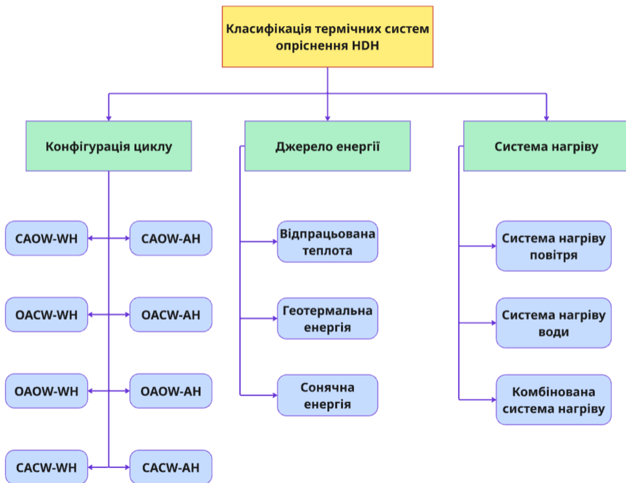
Рис. 1.2. Класифікація HDH-систем опріснення
