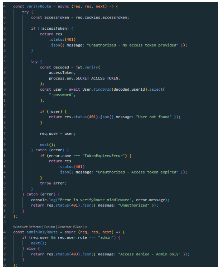
Рисунок 3.12 – Програмна реалізація middleware автентифікації та перевірки ролі
