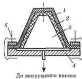
Рис. 5.3 Схема вакуумного формування
