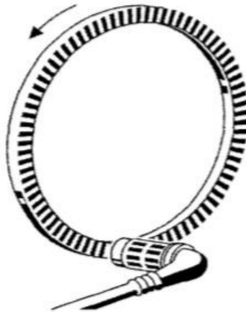
Рисунок 1.3 – Зубчастий датчик швидкості колеса
