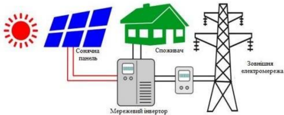
Рисунок 2.6 - Схема мережевої сонячної електростанції.
