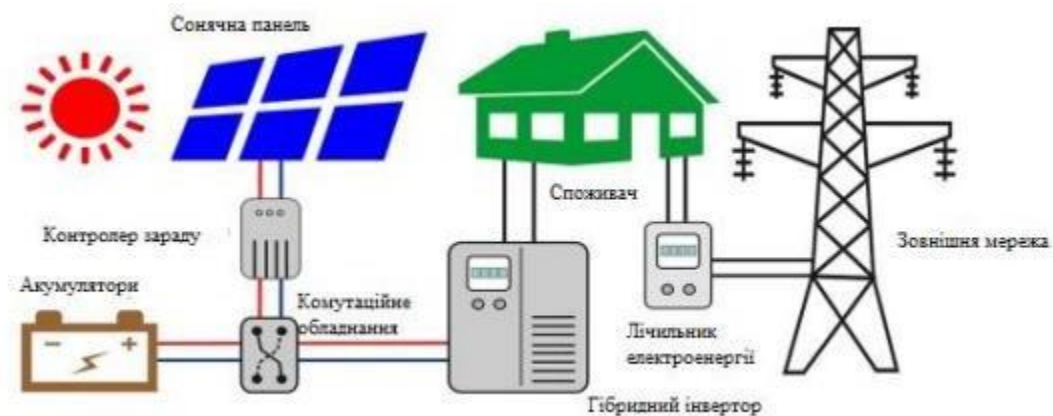
Рисунок 2.7 - Схема автономної, з'єднаної з мережею (гібридної) СЕС.
