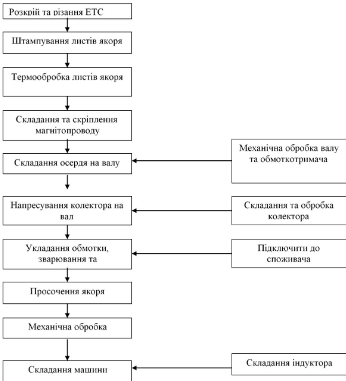
Рисунок 2.1- Схема виробництва якоря стартера
