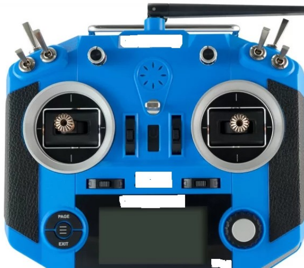
Рисунок 9 – Зовнішній вигляд типового пульта дистанційного управління для моделі літака або планера
