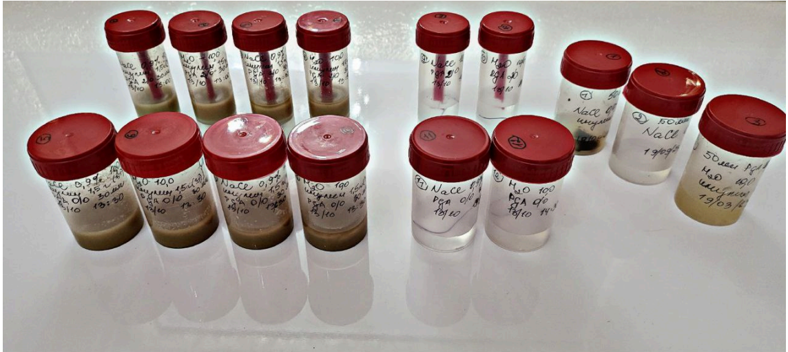
Рисунок 2.5 – Підготовлені зразки біодеградуючого шовного матеріалу з полігліколевої кислоти у розчинах інуліну у H_2O та у NaCl 0,9%
