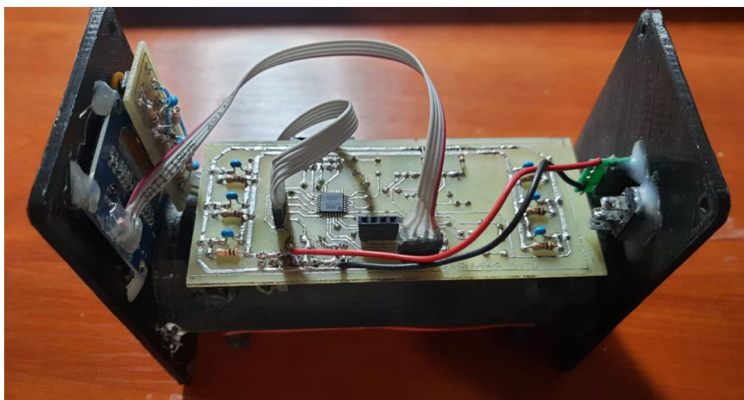
Рисунок 6.7 – Плата закріплена на корпусі датчика
