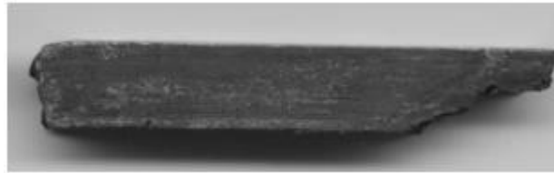
Рис. 1.3 Вид танталової заготівлі після 14 проходів РКУП при температурі 450 °С
