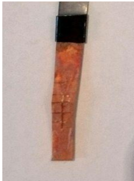
Рис.2. 1 Зображення мідного визначення міцності адгезії якісним методом нанесення сітки подряпин
