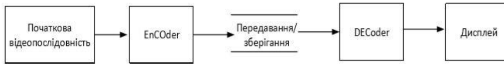
Рис. 1.3 Принцип системи роботи кодеків
