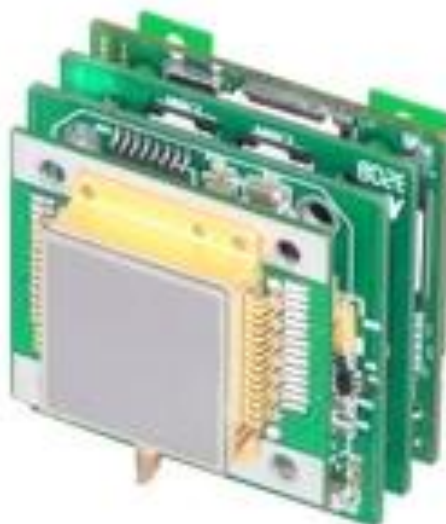
Рисунок 1.10 – Зовнішній вигляд матриці ASP-HR640 [15]
