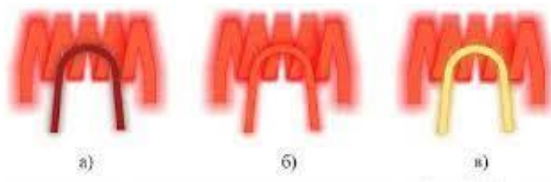
Рис. 5. При досягненні рівності яскравостей вершина нитки розжарення пірометричної лампи перестає розрізнятися на тлі спіралі досліджуваної лампи.
