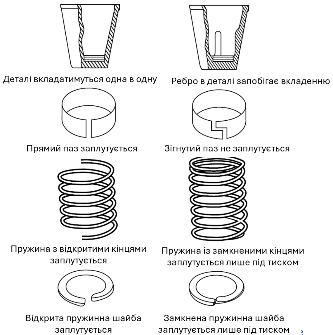
Рис. 14.9. Приклади редизайну для запобігання вкладеності або заплутування. (Iredale, R. Metalwork Production. )[11]
