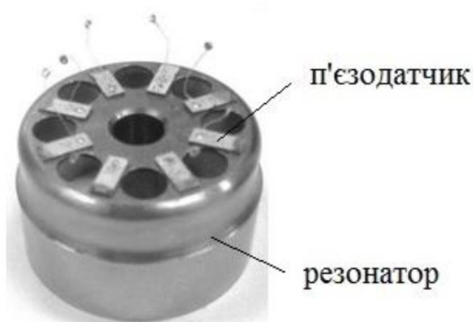
Рис. 22. розташування п'єзокераміки на резонаторі
