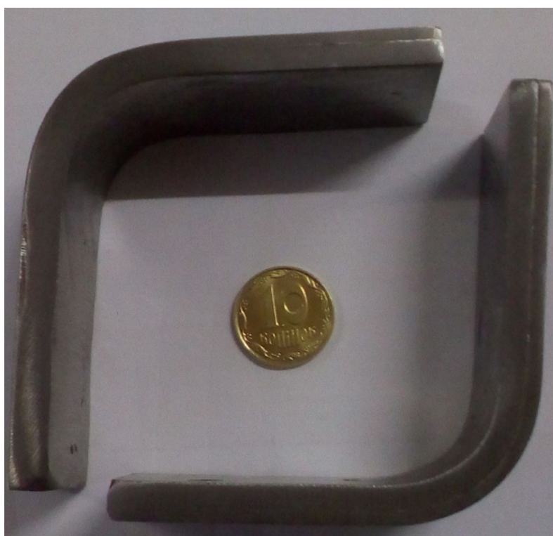
Рис. 4.11 - Приклад можливості отримання замкнутих контурів при використанні гнутих під кутом в 90^\circ біметалів
