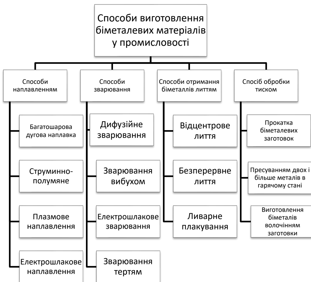
Рис. 1.10 - Способи виготовлення біметалів у промисловості.
