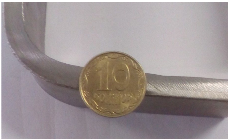
Рис. 4.10 - Приклад згинання біметалу на кут в 90^\circ при надійному зчепленні його пластин
