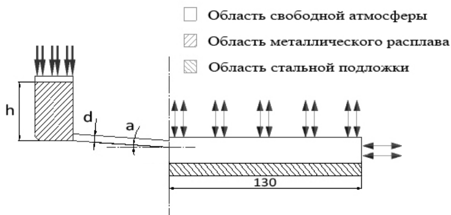
Рис. 2.34 - Структура розрахункової області течії металевого розплаву по твердій заготовці
