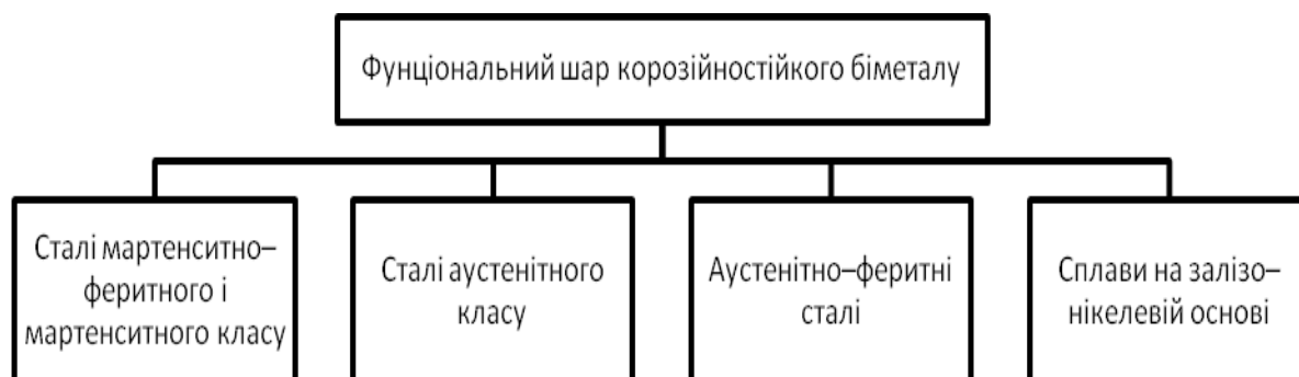
Рис. 1.1 - Види корозійностійких сплавів сталі для використання в якості функціонального шару біметалу
