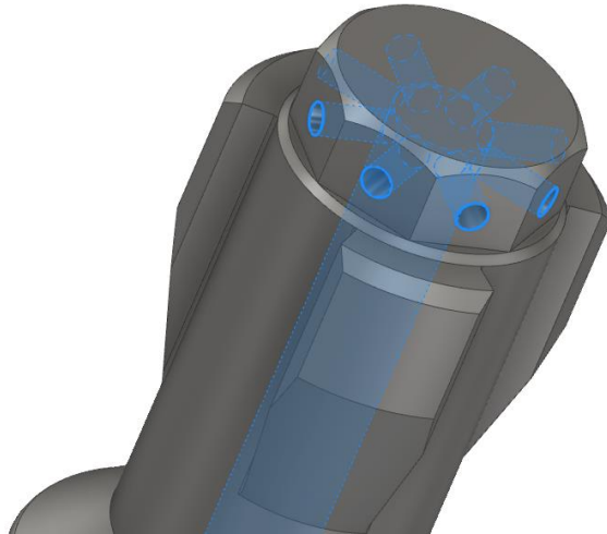
Рисунок 2.23 – Канали для відводу МОР
