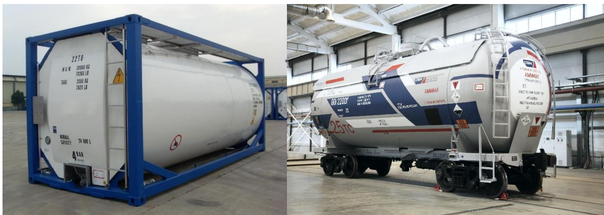
Рис. 1.1. Приклади резервуарів для зберігання та перевезення рідин.
