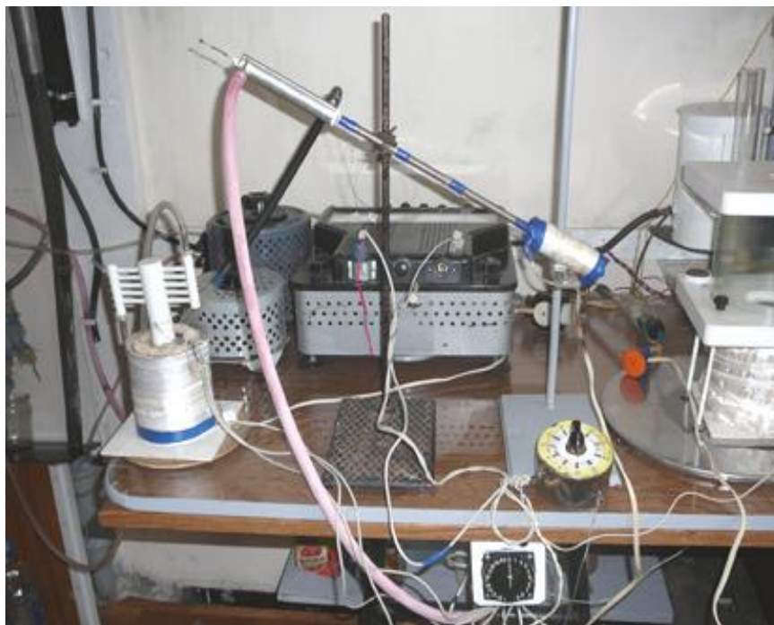
Рисунок 4.9 – Загальний вигляд експериментальної установки, призначеної для досліджень характеристик теплових труб
