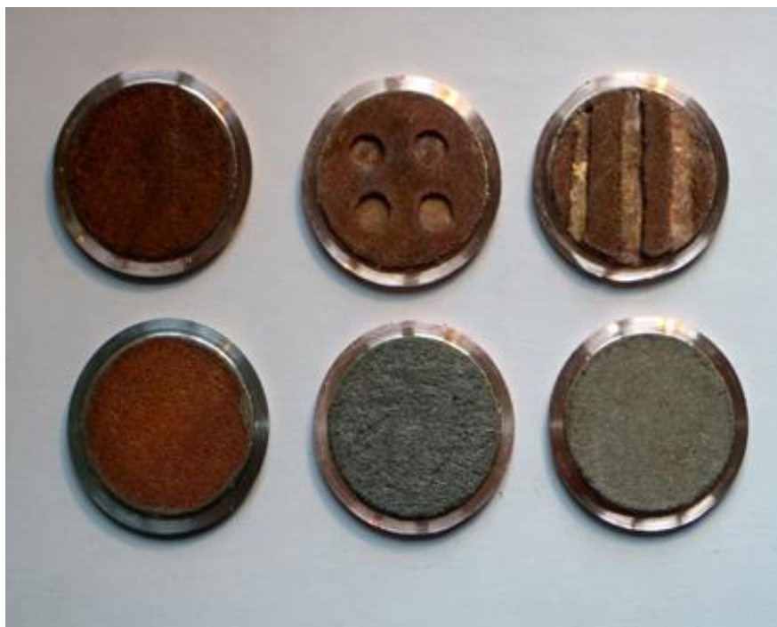
Рисунок 2.3 – Дослідні зразки капілярно-пористих структур різних типів
