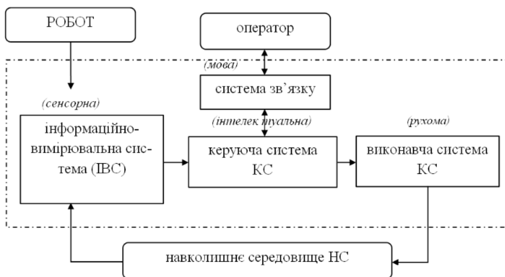
Рисунок 1.3– Узагальнена структура сучасної робототехнічної системи [8]
