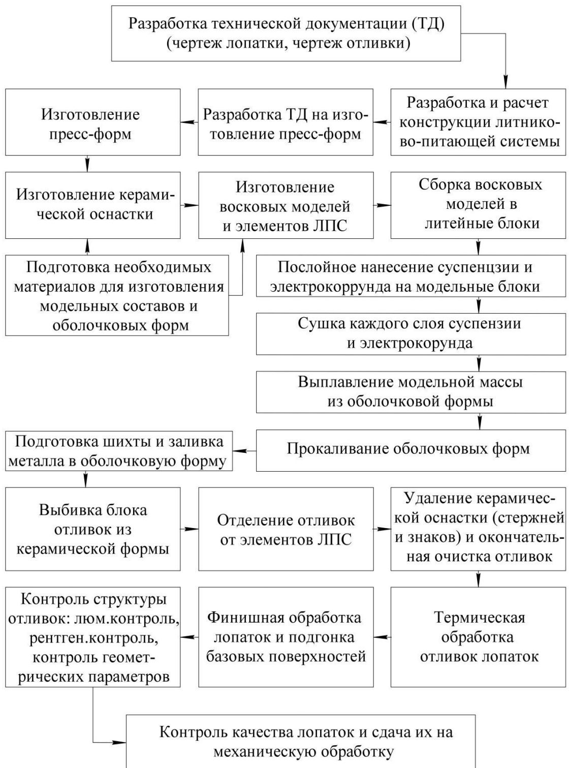
Рисунок 1.7 - Укрупнений типовий технологічний процес виготовлення робочих лопаток турбіни ГТД методом лиття з СК в оболонкові форми
