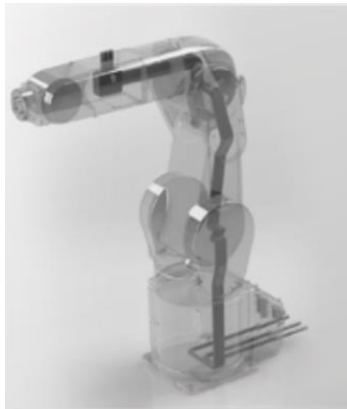
Рисунок. 2.4.1.2. Внутрішнє розташування дротів і каналів маніпулятора
