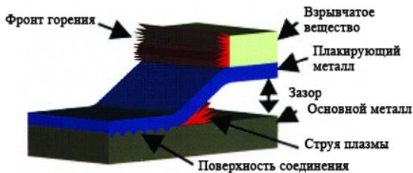
Рисунок 1.6 Схема процесу зварювання вибухом
