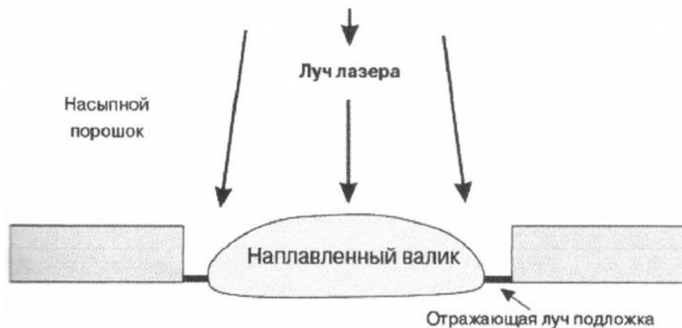
Рисунок 1.12.1 Схема нанесения покрытий оплавлением поперечно нанесеного порошку
